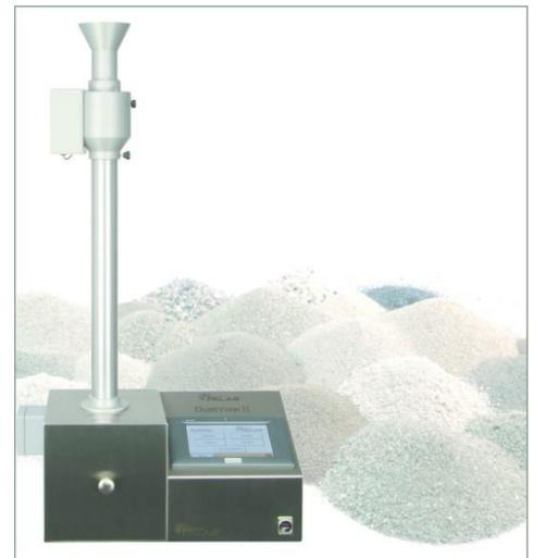
Le "Dust number" est une référence pour déterminer le comportement d'une poudre. La chute d'une quantité de poudre d'environ 30 g est programmée dans l'analyseur. Un détecteur laser permet de mesurer en continu et en temps réel l'atténuation de la concentration de poussière remise en suspension. Ce protocole permet d'obtenir la valeur suivante :
