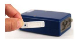
Une fois les mesures effectuées, le logiciel permet de décharger la mémoire interne à l'aide d'un simple port USB et de visualiser les données, tout en rechargeant la batterie. Ce logiciel permet également le paramétrage et la mise à jour de l'analyseur par l'utilisateur.
