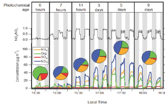
Ci-dessus : Mesures obtenues avec un réacteur PAM lors de l'oxydation d'émissions de véhicule motorisé dans le tunnel Fort Pitt à Pittsburg, Pennsylvanie, USA. Les périodes grisées correspondent aux périodes de by-pass du réacteur.
