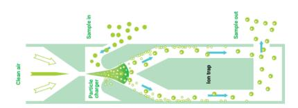
L'analyseur est équipé d'un éjecteur et est associé à un compresseur intégré qui génère un air comprimé propre et sec. L'écoulement d'air comprimé crée une dépression au niveau de l'entrée échantillon, permettant ainsi d'aspirer l'échantillon dans l'analyseur.
