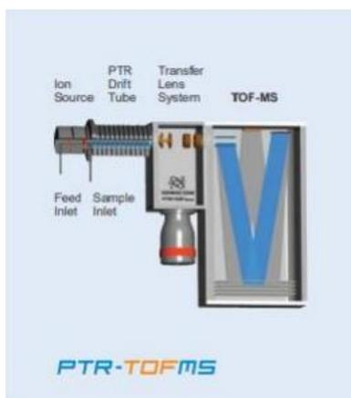
Les composés ionisés vont parcourir un trajet avec la même énergie cinétique, et seule leur masse permettra de les séparer. Les composés les plus lourds vont donc mettre plus de temps à parcourir l'analyseur que les composés légers. A chaque extraction, tout un spectre de masse est mesuré en même temps. La performance de la séparation est ce que l'on appelle la résolution massique. Avec les analyseurs à temps de vol, cette résolution en masse est suffisamment haute pour les composés isobariques.
