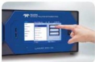
Comme tous les analyseurs de la série T, le modèle T100 possède un écran tactile couleur avec une interface intuitive, des entrées / sorties flexibles et une mémoire interne. Tous les outils de configuration, de contrôle et d'accès aux données et aux informations de diagnostic sont disponibles via l'affichage avant ou via les ports de communication RS232, Ethernet ou USB, localement ou par connexion à distance.
