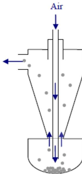
Schéma de fonctionnement du générateur
