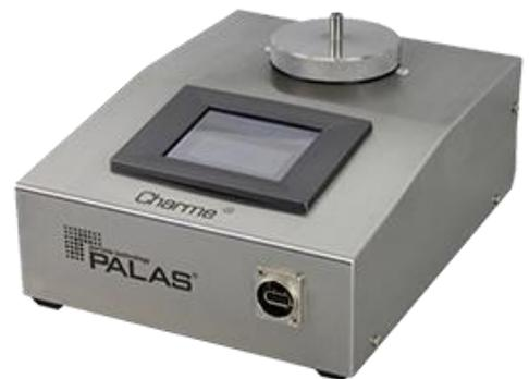
Le principe de mesure par électromètres est également la méthode de référence pour la calibration des compteurs de noyaux de condensation, selon la norme ISO 27891. En effet, il n'existe pas de standard pour le comptage en nombre, alors que la mesure de courant peut être reliée à un étalon primaire.
