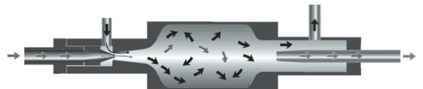
Le principe de fonctionnement est basé sur la dilution par éjection. La dépression imposée au niveau d'un orifice critique crée une aspiration par effet venturi. L'air comprimé propre et sec vient se mélanger dans une chambre de turbulence avec l'aérosol prélevé, celui-ci est donc instantanément dilué. Ce dispositif demande un apport en air comprimé propre et sec mais ne nécessite de système de pompage pour le prélèvement de l'aérosol.
