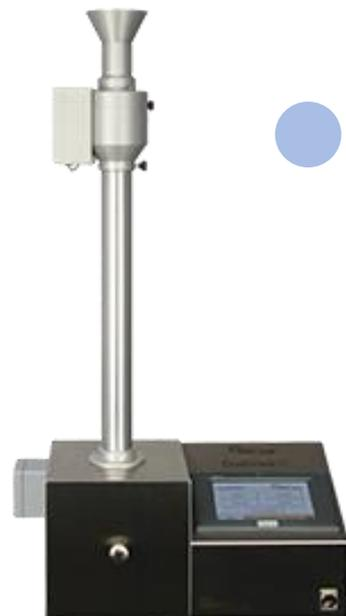
Le “Dust number” est une référence pour déterminer le comportement d’une poudre. La chute d’une quantité de poudre d’environ 30 g est programmée dans l’analyseur. Un détecteur laser permet de mesurer en continu et en temps réel l’atténuation de la concentration de poussière remise en suspension. Ce protocole permet d’obtenir la valeur suivante :
