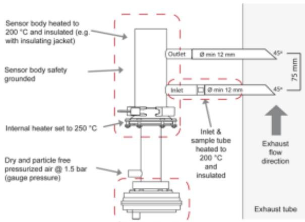
L'écoulement d'air comprimé crée une dépression au niveau de l'entrée échantillon, permettant ainsi d'aspirer l'échantillon dans l'analyseur.
