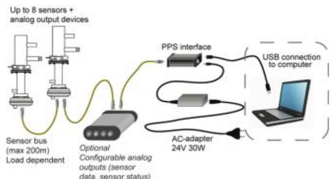
La technologie de l'analyseur PPS-M est basée sur la mesure de charges électriques portées par les particules. Il s'agit d'une méthode non collective, limitant fortement la fréquence des opérations de nettoyage et de maintenance.
