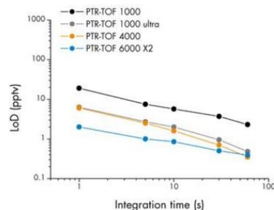
l'efficacité de transmission des ions de leur ionisation jusqu'au détecteur, et également du temps d'intégration. A titre d'exemple, pour un temps d'intégration de 1 minute, une limite de détection inférieure au ppt est atteinte avec la majorité des PTR-ToF-MS.
