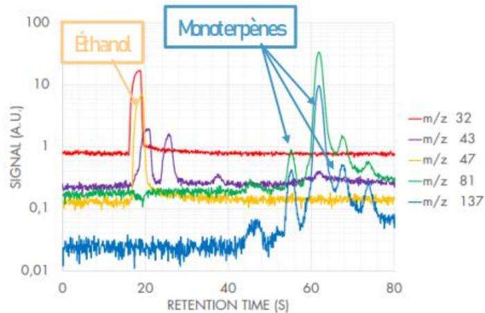
La fast-GC possède un autre avantage lors de la mesure de composés présents dans une matrice à haute concentration. Par exemple, la haute concentration en éthanol dans le volume de tête d'un échantillon alcoolisé peut consommer les ions primaires et rendre la quantification voire la détection impossible.
