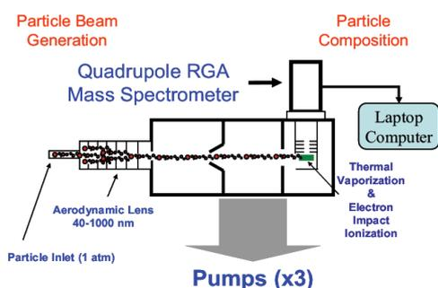
La conception de le Q-ACSM est basée sur l'AMS (Aerosol Mass Spectrometer), tous deux développés par la société Aerodyne Research, Inc. (Billerica, USA). Le principe repose sur l'utilisation combinée des techniques de vaporisation thermique des aérosols (~600°C), d'impaction d'électrons et de détection par spectrométrie de masse (Quadripôle).
