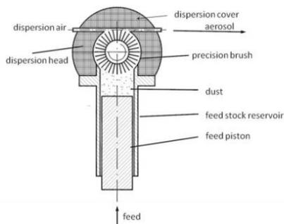
L'ensemble "tête de dispersion" comprend un couvercle de dispersion, une brosse de précision et un réservoir de matériau solide. La brosse rotative vient lécher la poudre alimentée en continue par un piston venant pousser la poudre du réservoir vers la brosse rotative à une vitesse ajustable.
