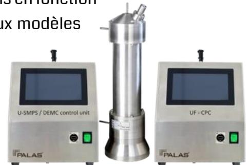
Après une phase de conditionnement de l'aérosol (séchage et neutralisation de l'aérosol afin d'obtenir une répartition connue de charges sur l'aérosol), l'échantillon pénètre la colonne DEMC de l'U-SMPS. L'échantillon vient longer les parois de l'électrode externe alors qu'un air de balayage est lui amené autour de l'électrode centrale.
