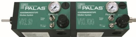
Les diluteurs VKL sont extrêmement stables en termes de facteurs de dilution et permettent un facteur de dilution nominal de 10, 27 ou 100. Montés en cascade, ils permettent d'atteindre des facteurs de dilution de 100 000.
